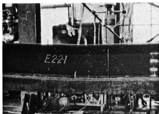
(d) 桁の疲労破壊全景 (E2-2-1)
