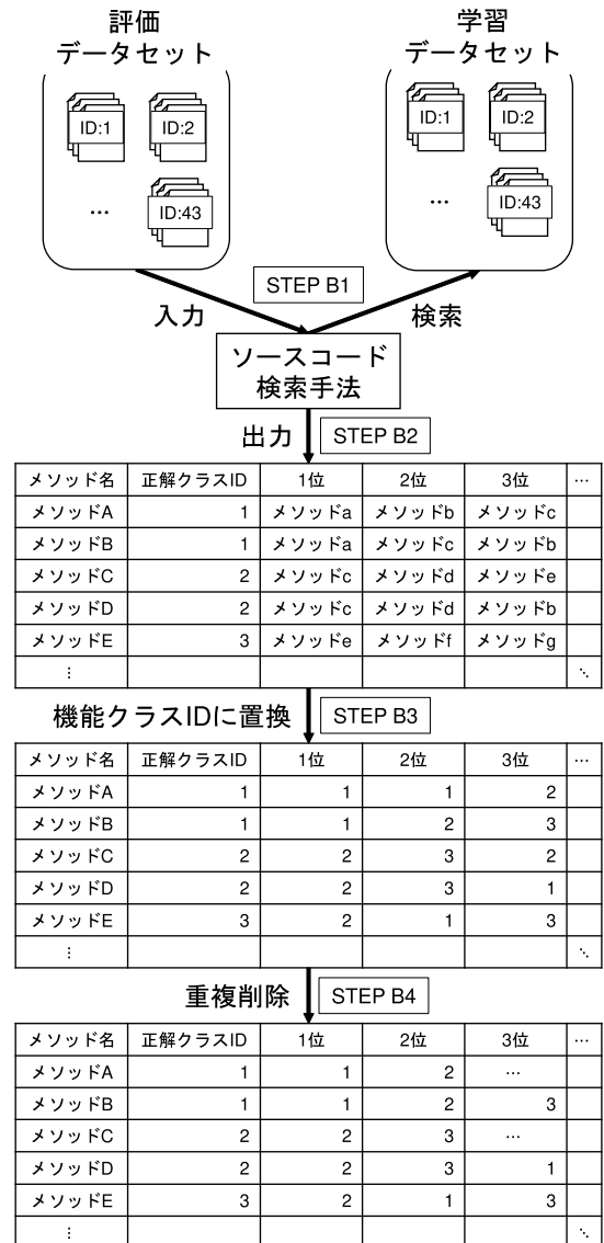
図5 意味的類似ソースコード検索手法を用いてランキングを作成する手順
