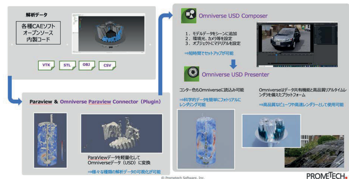
図 2 : NVIDIA Omniverse によるシミュレーションデータワークフロー
