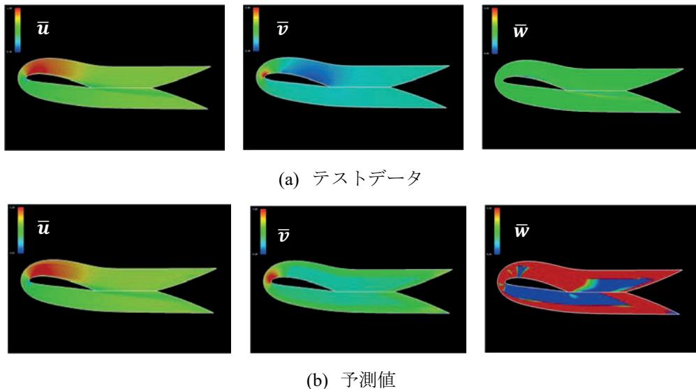
図 4 : 拡張された速度場の時間平均・スパン方向平均分布[6]
