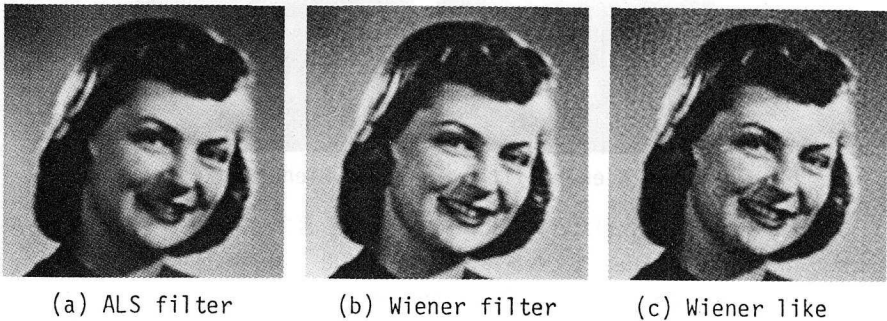
Fig. 5.7 ALS フィルター、Wiener フィルターおよび擬似Wiener フィルターを Fig. 5.6 (a) の劣化像に適用した時の修正結果 (a) ALS フィルター、(b) Wiener フィルター、(c) 擬似Wiener フィルター
