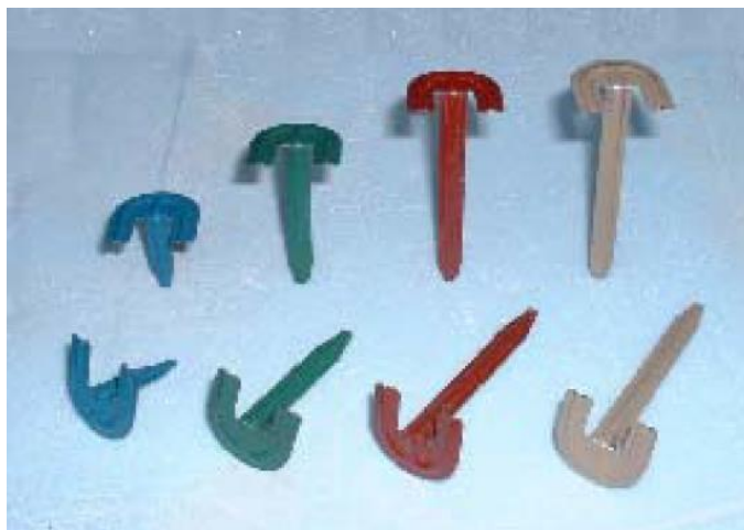
図 4.1 耐火被覆の厚さ確認ピン
