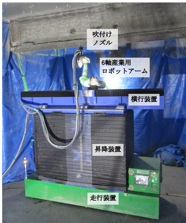
図 4.8 開発した耐火被覆吹付けロボット
