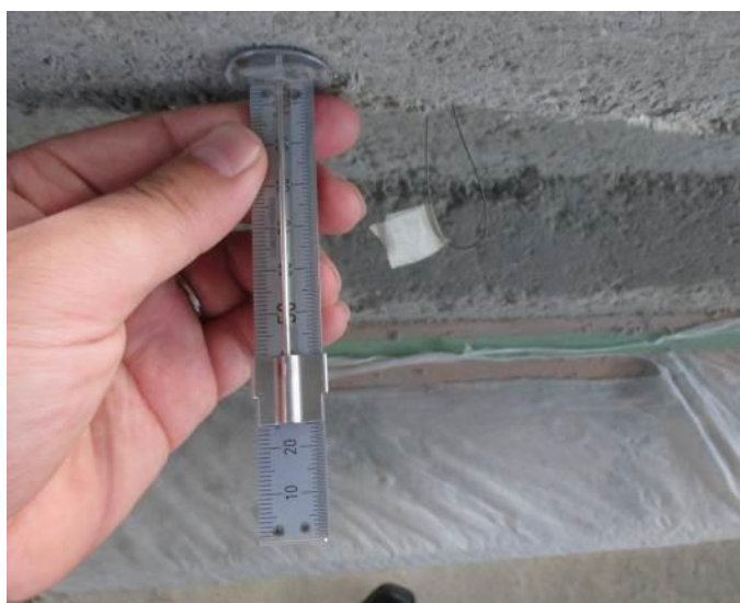
図 4.3 自主検査用の耐火被覆の厚さ測定器具
