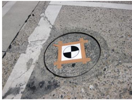
図 3.10 地上コントロールポイント
