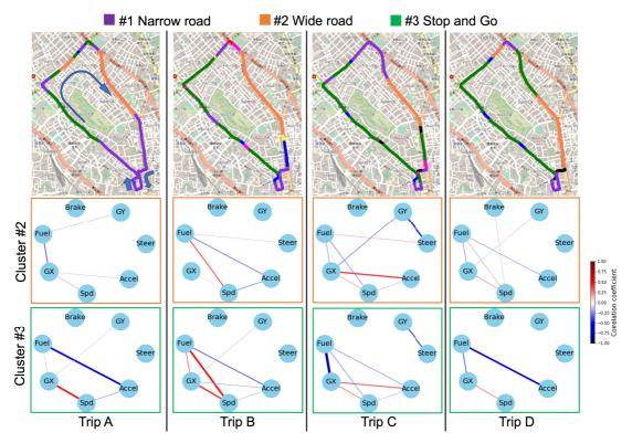
図 10 車両走行センサデータ:市街地における NGL の出力例
