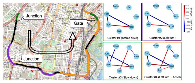
図 1 車両走行センサデータ:高速道路における NGL の出力例(GY = 左右加速度、Steer = ハンドル角、Accel = アクセルペダルストローク、Spd = 速度、GX = 前後加速度、Fuel = 燃費、Brake = ブレーキペダルストローク)
