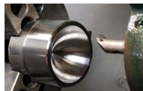
SUS 材の曲面くぼみ加工
