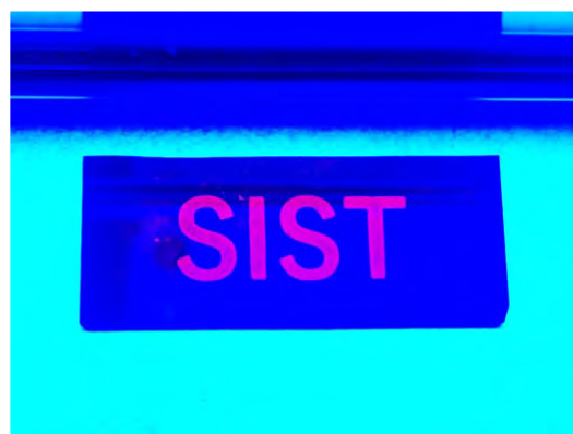
図 1 電子線照射により Si 基板上に形成した CdSe/CdS 量子ドット内包 PS パターンの写真。写真は、ブラックライト照射下でのパターンからの発光の様子である。
