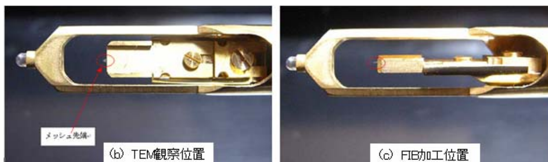
図2. 4. 12 リデポジション抑制のための試料メッシュと試料台
