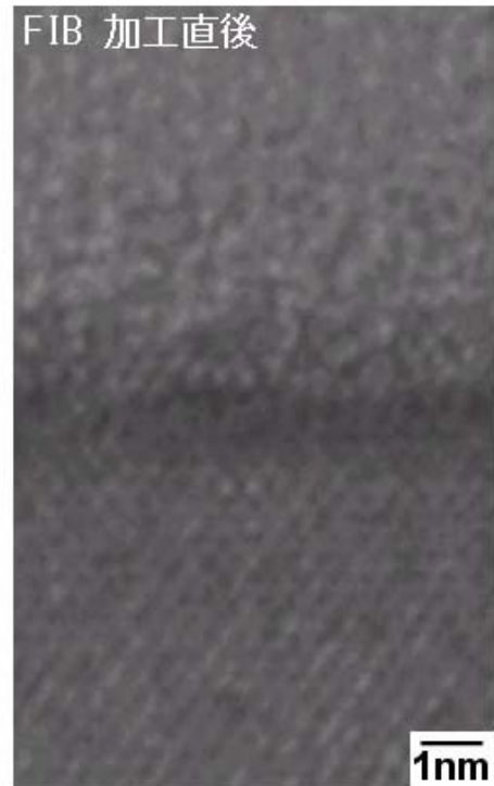
図2. 4. 9 Gaイオンダメージの影響 (b) 格子像の劣化
