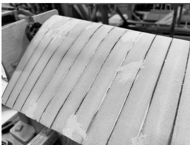
図 19 穴埋めパテによる再成形
