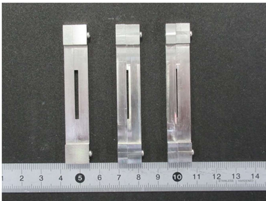
図 1. 3 点曲げ試験の試験片作製のステンレス製金型 サイズ：幅 2.0 mm，長さ 25 mm，厚さは左から順に 2.0, 1.0, 0.5 mm.
