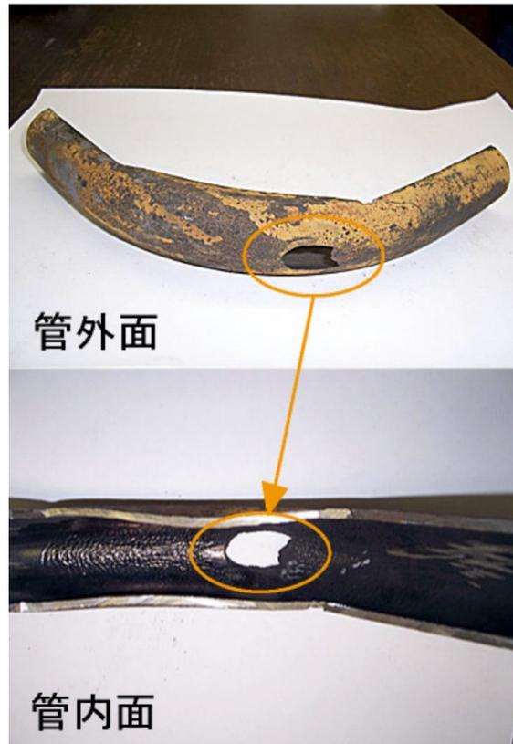
図 1.2.4.1-22 FAC による低圧蒸発管 曲がり部の破孔(1)<sup>(82),(91)</sup>
