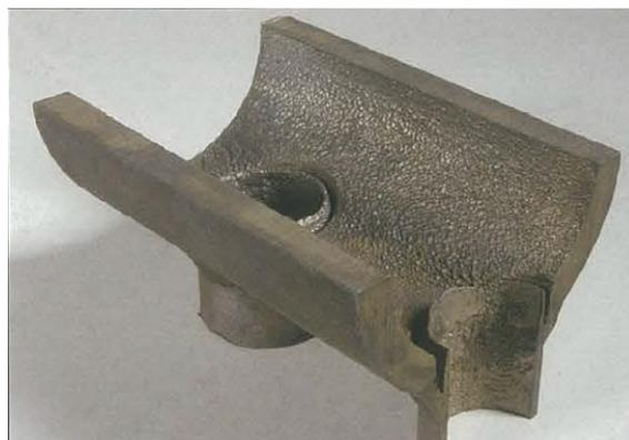
図1.2.4.1-21 FACによる高圧節炭器ヘッダー部の減肉<sup>(90)</sup>
