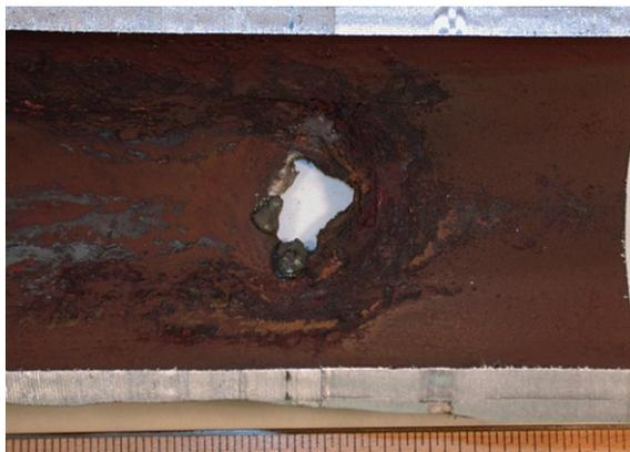
図 1.2.4.3-3 酸性りん酸塩腐食による蒸発管の破孔<sup>(98)</sup>
