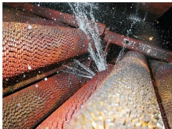
図 1.2.4.1-24 FAC による蒸発管の破孔<sup>(92)</sup>
