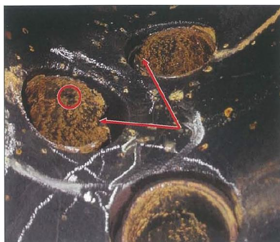
図1.2.4.1-19 FACによる節炭器ヘッダー部入口配管の減肉<sup>(90)</sup>
