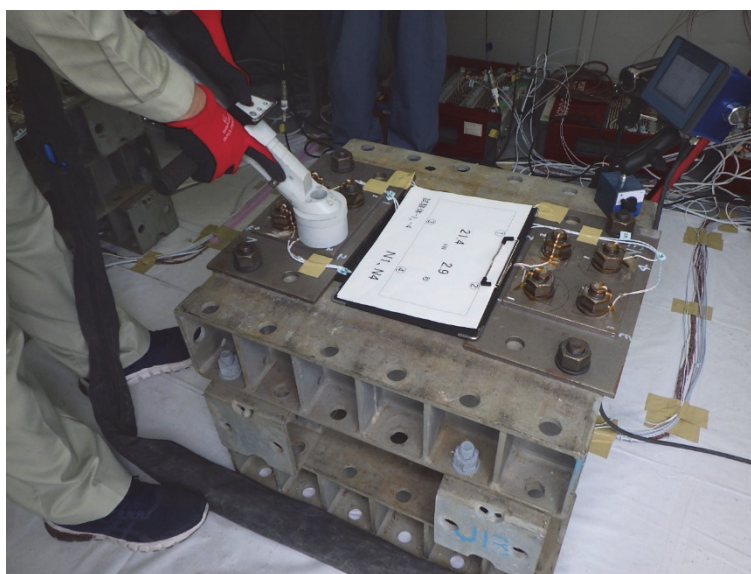
図-2.21 高力ボルトの加熱状況
