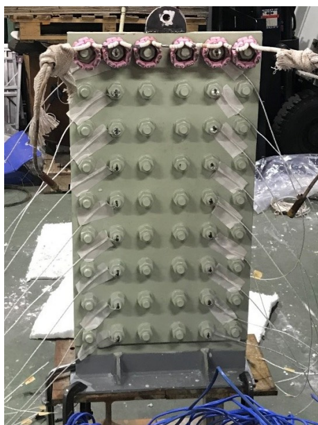
図-5.2 ヒーターユニットの設置状況
