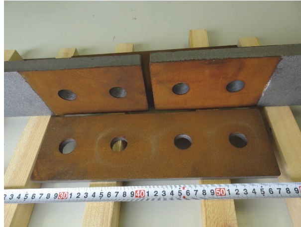
図-4.2 引張実験供試体の摩擦接合面
