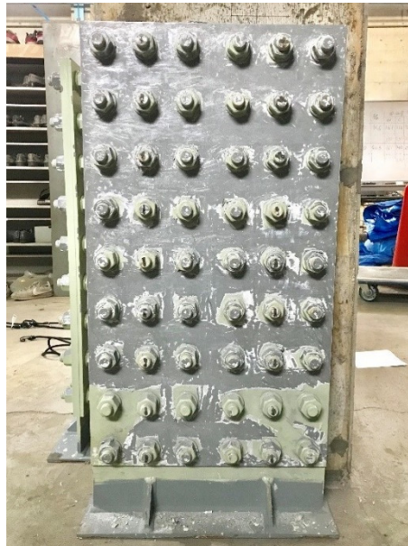
図-5.8 ヒーター2ユニットによる塗膜剥離後の供試体の状況
