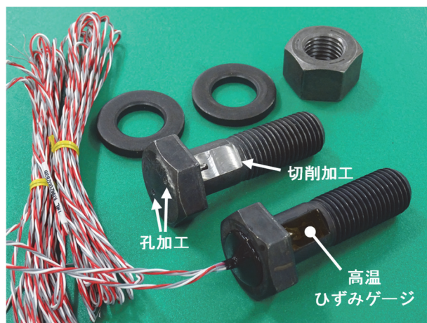
(a) ひずみゲージ取付ボルトの形状
