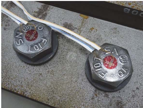
(a) 2軸ひずみゲージの貼付状況
