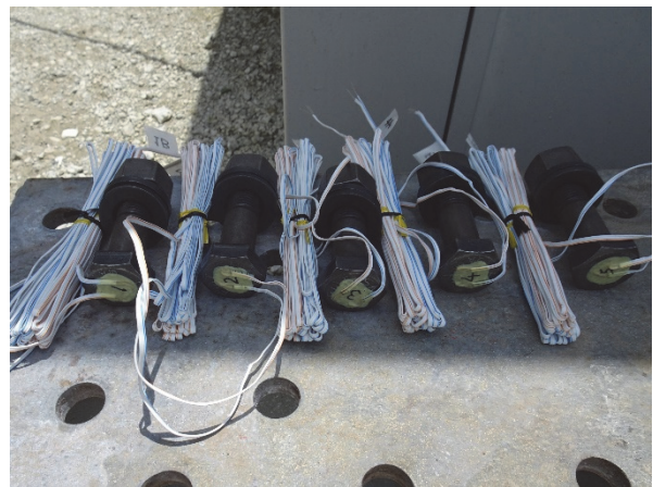
(b) キャリブレーションに使用した高力ボルト
