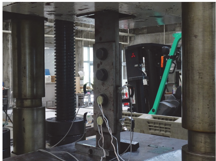
図-4.14 クリップ型変位計の配置と引張実験状況
