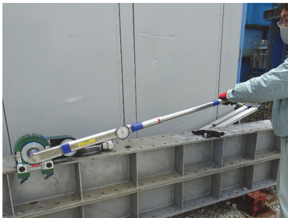
(a) 油圧式軸力計とキャリブレーションの状況
