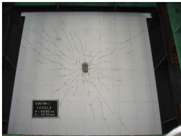
(b) N=90.5\text{kN} (短期許容パンチング耐力相当) 時
