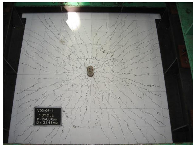
(c) 最大荷重 N=154.0\text{ kN} 時
