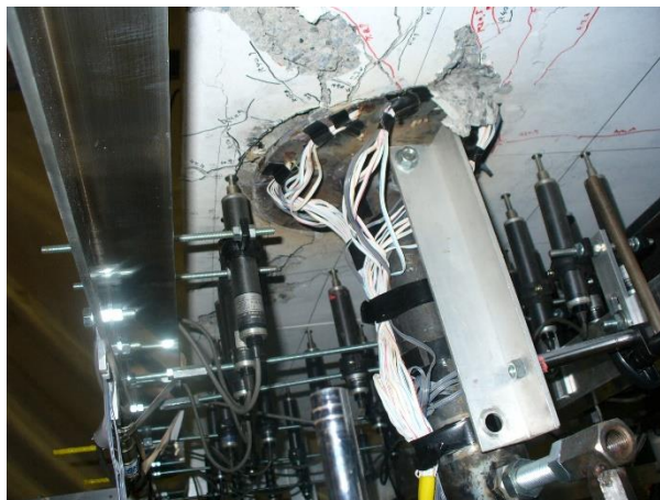
(c) R = 40.1 \times 10^{-3} \text{rad} 時のスラブ下面状況
