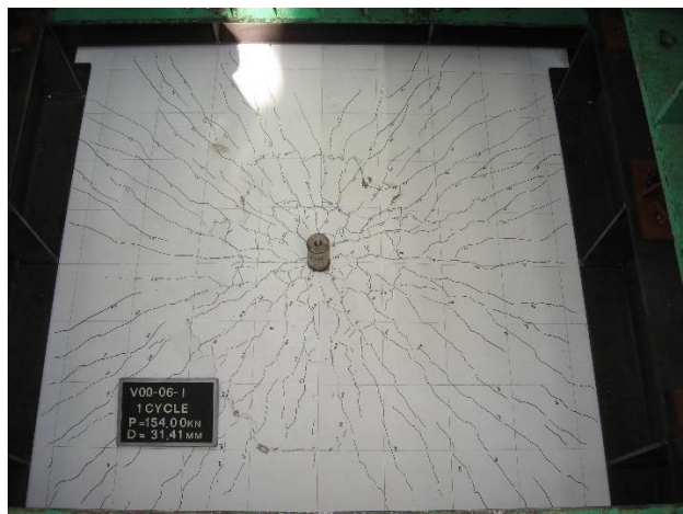
(c) 最大荷重 N=154.0\text{ kN} 時
