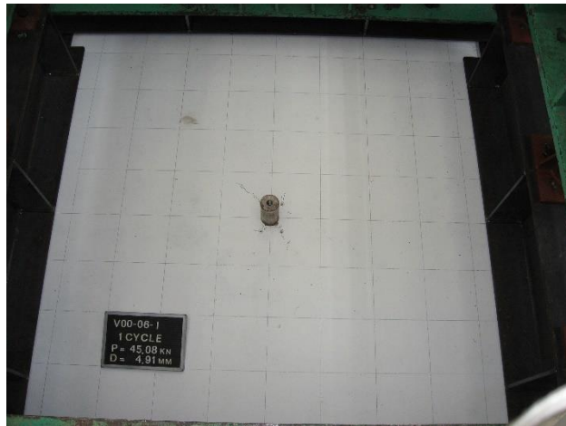
(a) N=45.2\text{kN} (長期許容パンチング耐力相当) 時
