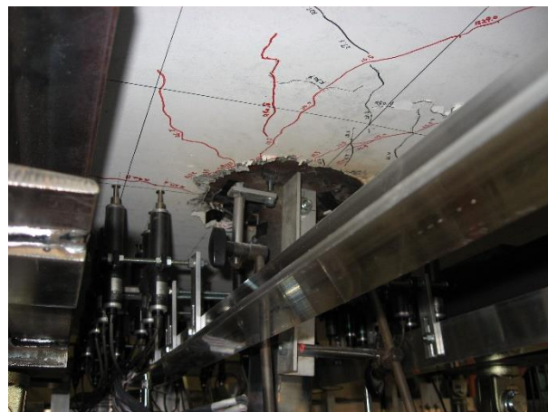
(c) R = 104.5 \times 10^{-3} \text{rad} 時のスラブ下面状況
