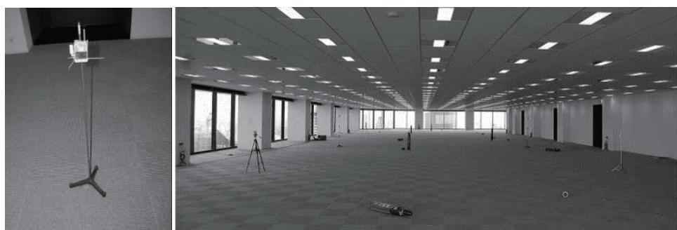
図3-6 トレーサーガス法測定時の様子
