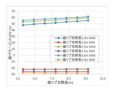
図-2.18 縦リブ・横リブ支間を変化させたときの曲げモーメント
