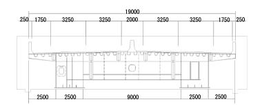
図-2.16 鋼床版箱桁の標準断面
