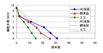
図-1.2 舗装の劣化モデルの例 <sup>5)</sup>
