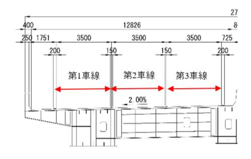
図-2.3 片側3車線,箱桁の断面
