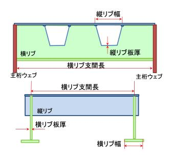
図-2.4 縦リブ,横リブ諸元の設定位置
