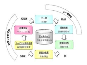
図-1.1 阪神高速のアセットマネジメントシステム
