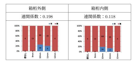
図-2.10 横リブ板厚とき裂発生割合
