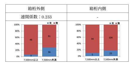
**図-2.9** 横リブ支間長(7,500mm)とき裂発生割合注)「-」は統計的に有意ではないことを示す.
