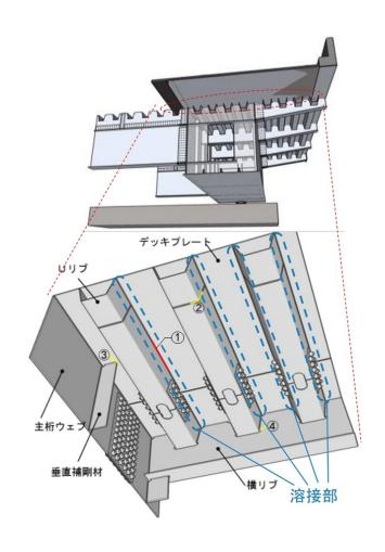
図-3.1 鋼床版の概要図
