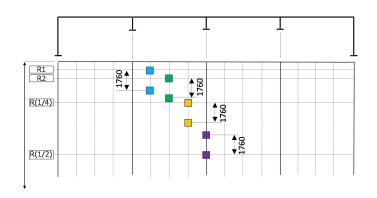
図-2.15 T 荷重の載荷位置
