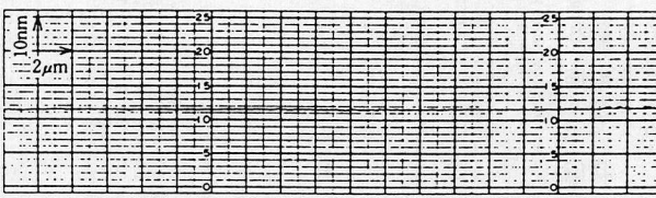
図4. タリステップ(分解能5 \text{\AA} )によって測定したNC EEMによる加工面の表面粗さ〔加工物; 単結晶 Si(111)〕
