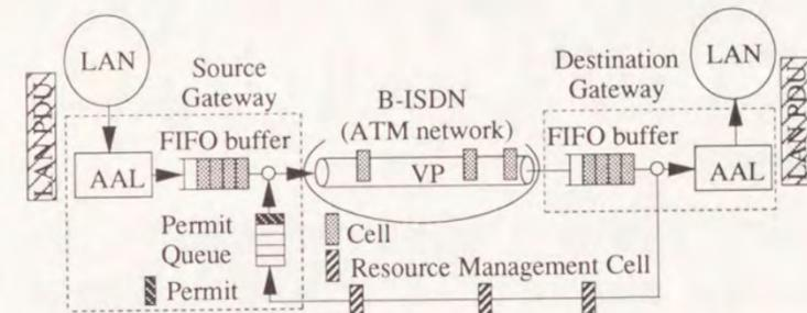
図 3.1 DGW 方式基本原理図
