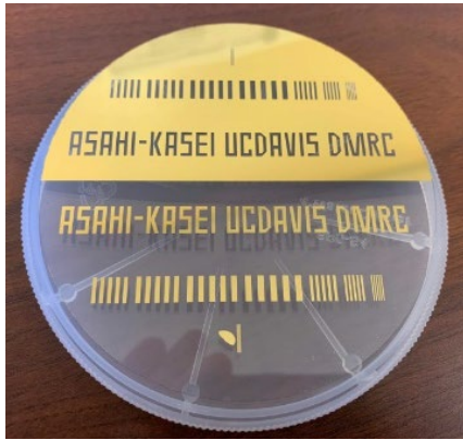
図 3.14 分解能評価用サンプルの写真
