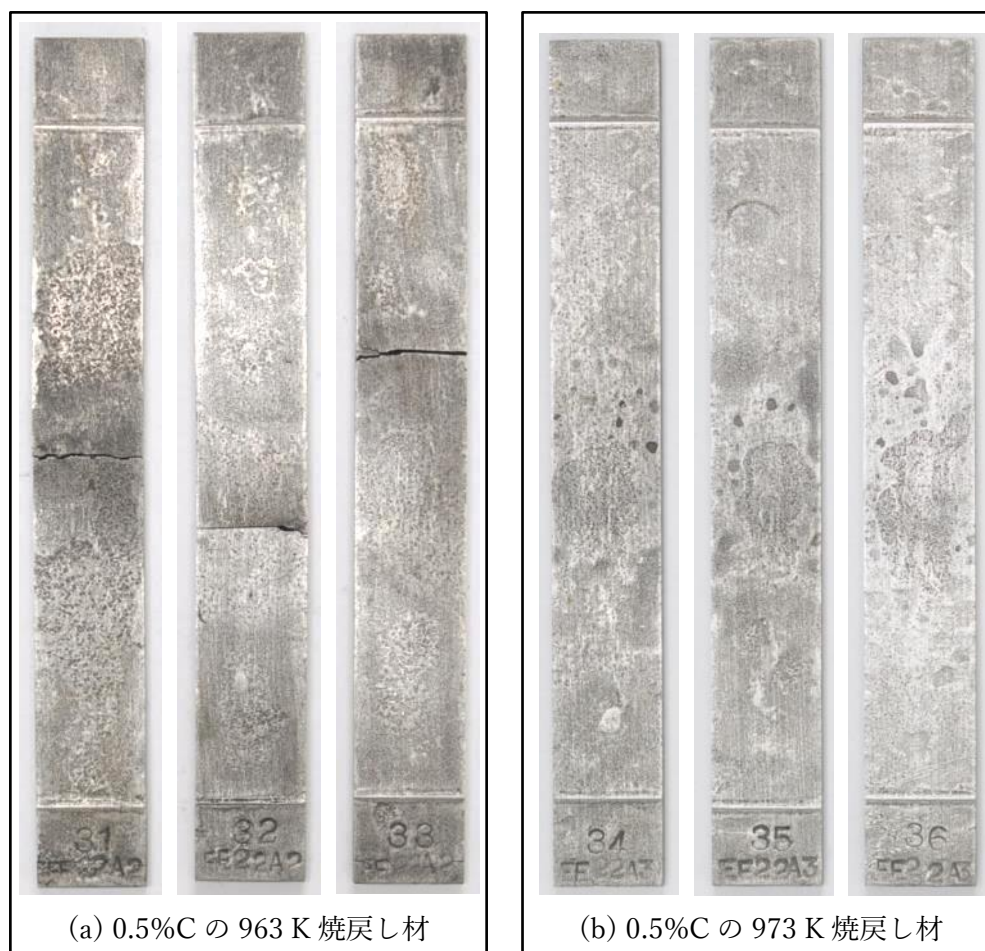
Fig. 3-18 0.5%C における四点曲げ試験後に腐食生成物を除去した試験片の写真、 (a) 963 K 焼戻し材、(b) 973 K 焼戻し材
