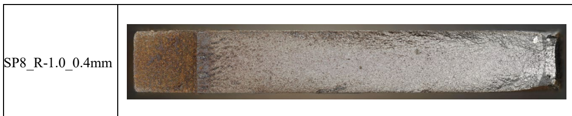
Fig. 4-18 破面画像（応力比 R=-1.0 ，腐食時亀裂長さ a_{co.}=0.4\text{mm} ）
