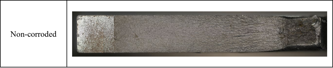
Fig. 4-13 破面画像（応力比 R=0.1 ，非腐食試験片）
