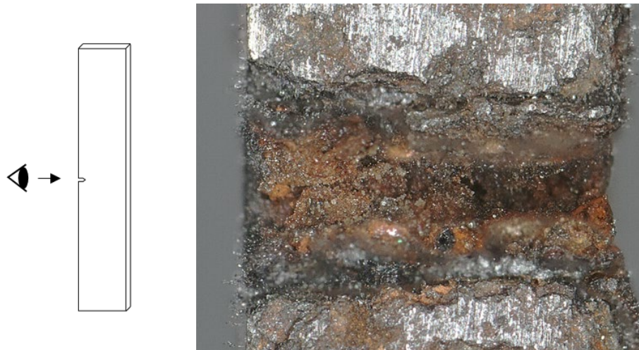
Fig. 3-10 試験片切欠き開口部の腐食状況
