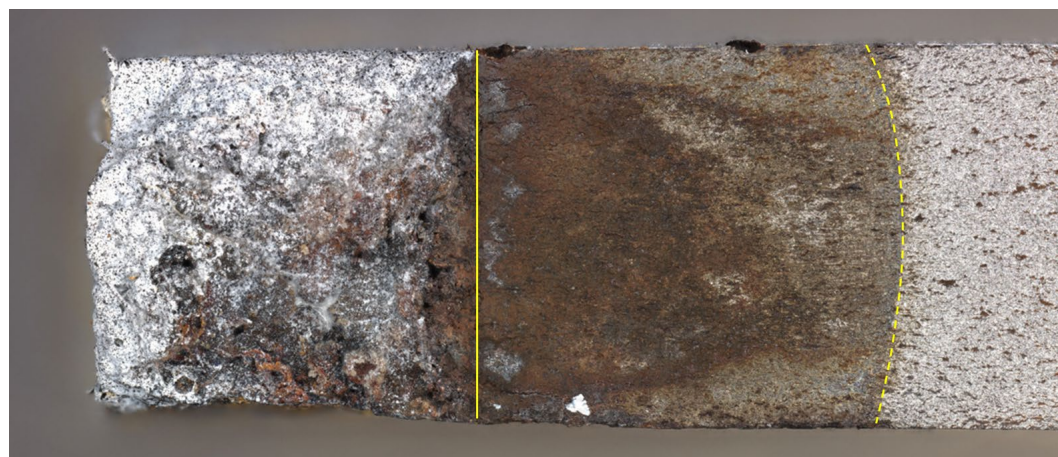
Fig. 3-18 疲労予亀裂長さ a_{co.}=3.0\text{mm} の試験片破断面
