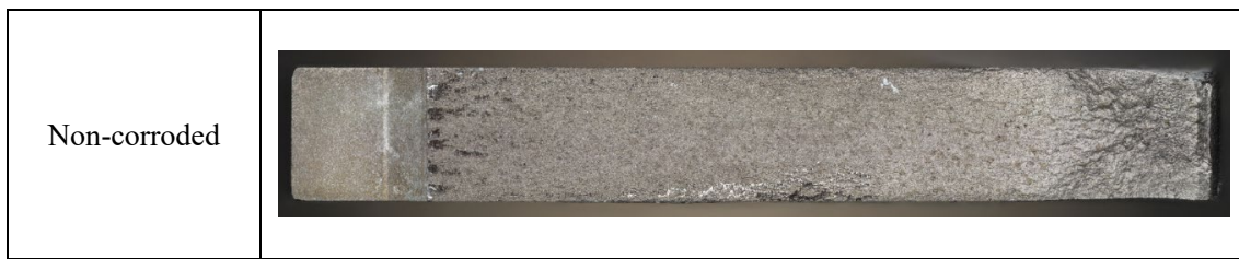
Fig. 4-16 破面画像（応力比 R=-1.0 ，非腐食試験片）
