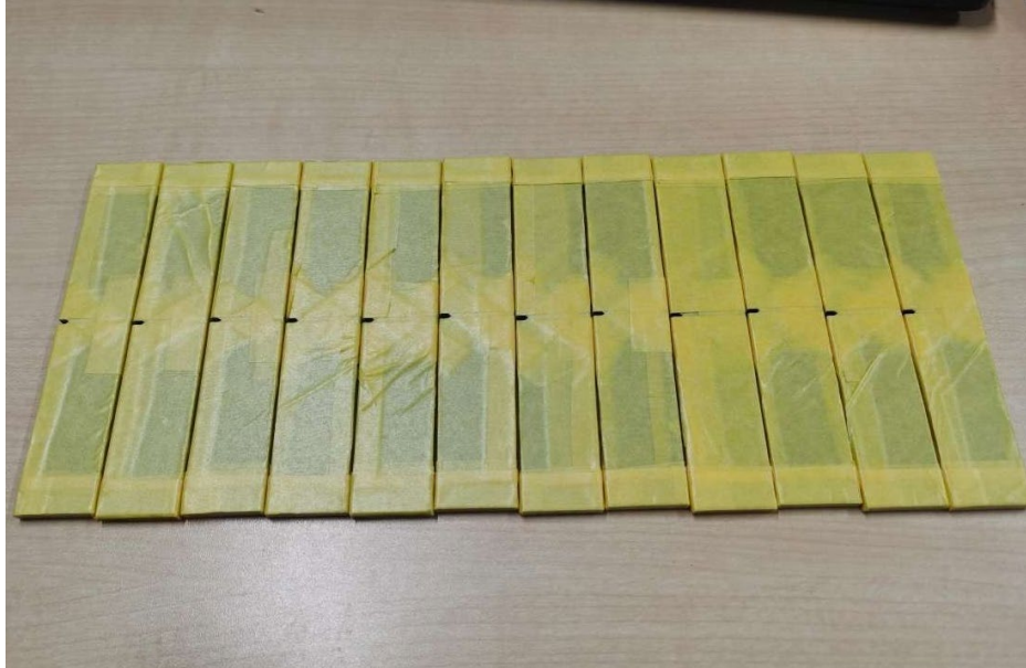
Fig. 3-3 疲労試験片の防食加工
