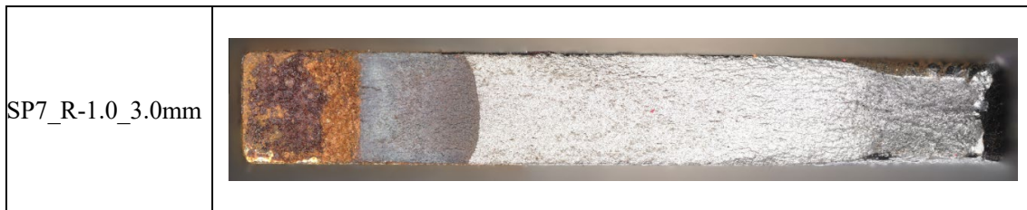
Fig. 4-17 破面画像（応力比 R=-1.0 ，腐食時亀裂長さ a_{co.}=3.0\text{mm} ）
