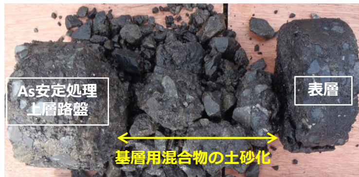
写真-1.3 基層用混合物の土砂化
