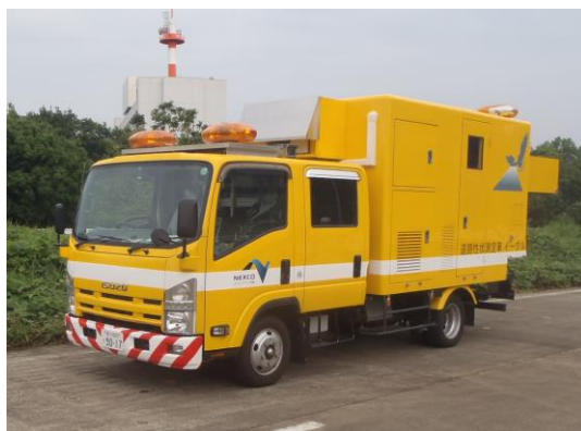
写真-4.1 路面性状調査車両
